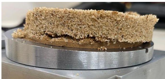
Рис. 5. Фотография разрушенного слоистого образца после проведения испытания на одноплоскостной срез
